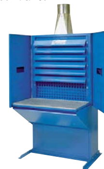
c) Table aspirante avec fentes d'aspiration face au travailleur
