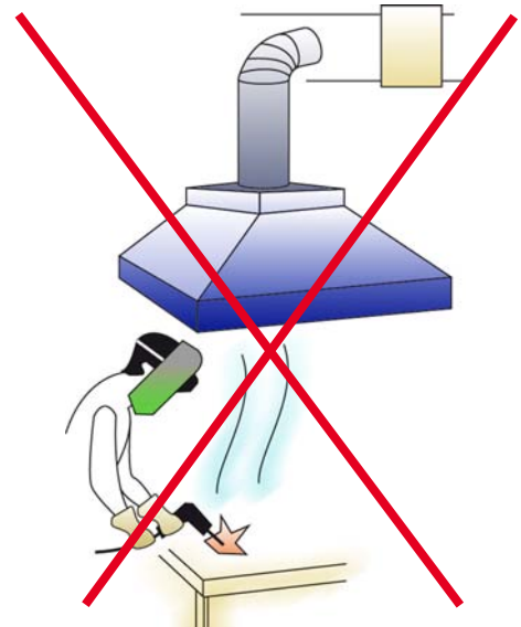
Figure 8.1 : Hotte fixe au-dessus de la table de travail réservée uniquement aux applications automatiques
